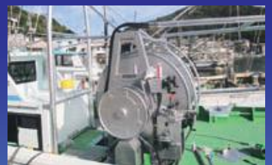
小型網引き船の作業能率の向上、労力の軽減を実現する強靱でコンパクトな井上式ネットローラー(揚網機)。
