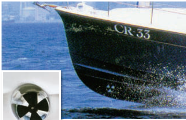
◀バウスラスターのトンネル穴とプロペラ
