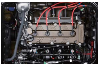
最大出力152PSを発生する、DOHC16バルブ水冷1,498cm エンジン。
