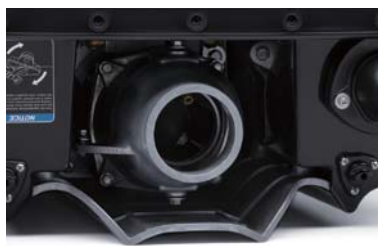
強大なエンジンパワーを効率よく推力に変換する、高性能ジェットポンプを装備。
