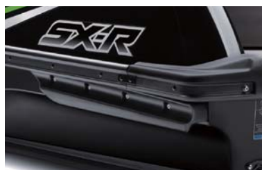
ハルの両サイドに取り付けられたスポンソンが、走行安定性を高めています。
