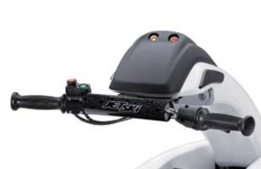
ハンドルボールのパッドに、燃料警告灯(左)とワーニングランプ(右)をビルトイン。
